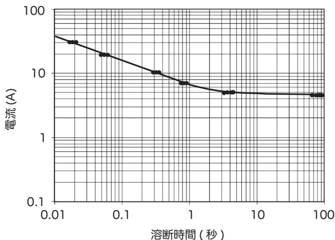
【図3】 溶断時間-電流特性の作成例
