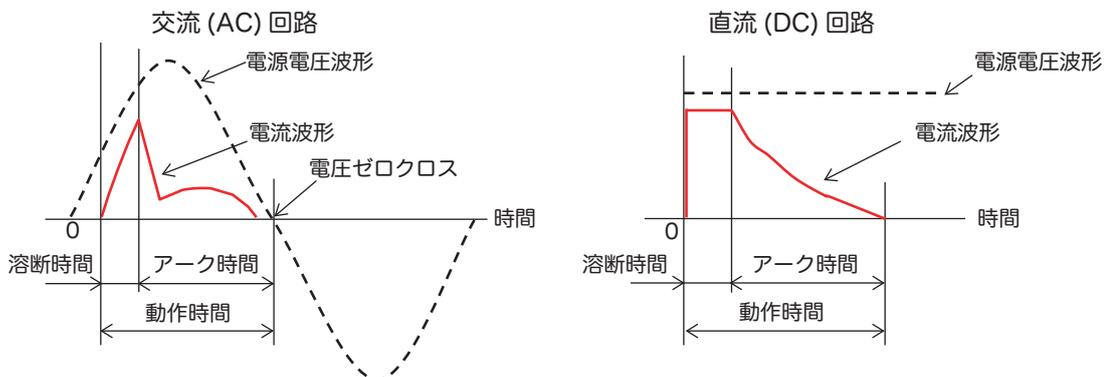
【図 1】 交流 (AC) 回路と直流 (DC) 回路の電流遮断波形の違い (イメージ図)
