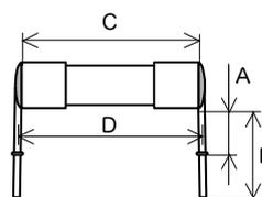
■ 25RT 型 ( 単位 : mm、リード径 :  $\phi$  0.8mm)
