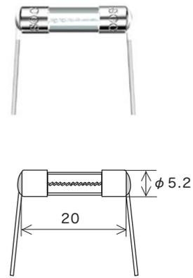
リード線径  $\phi$  0.5 (100mA ~ 4A)  $\phi$  0.8 (4A 超 ~ 10A) 倍率 1/1 (mm)
